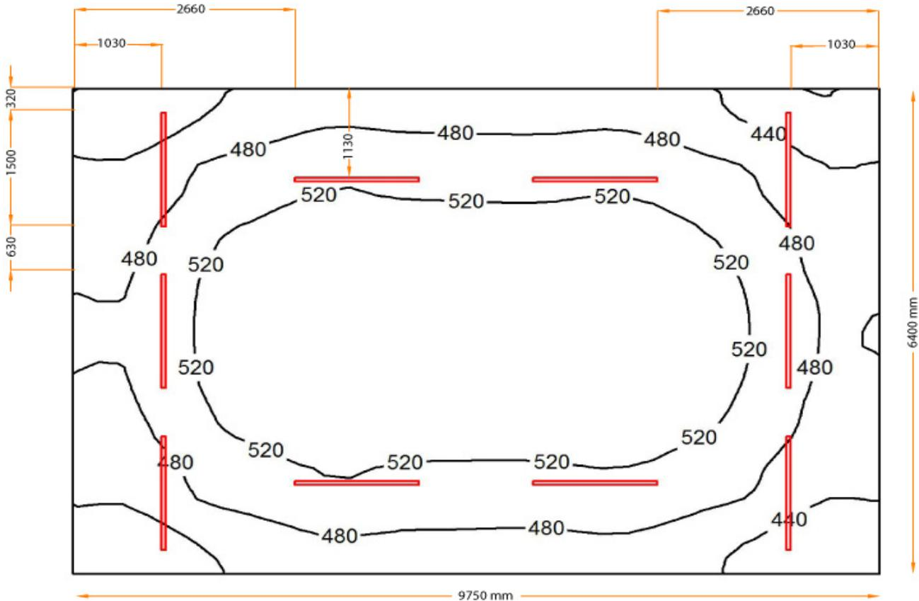
**Beschreibung:** Die CT LED Beleuchtung besteht aus 10 Aluminium silber eloxierten Lampen mit einer PU Abdeckung opal. Die Beleuchtungseinheiten werden direkt an die Decke montiert oder mit einem Stahlkabel 1,5 mm mit Deckenklips. Der LUX Level, gemessen 1 Meter über dem Boden, wird im Squash Court an keiner Stelle mehr als 15% von dem empfohlenen Level von 500 LUX Beleuchtungsstärke abweichen.
